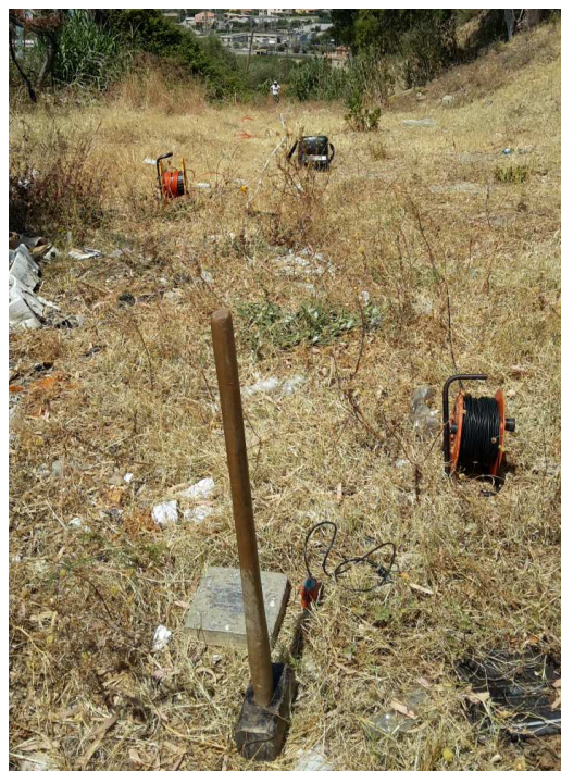
Foto 13: Stendimento sismico M2
