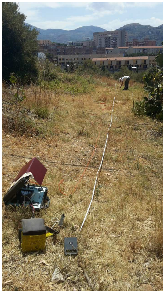
Foto 14: Stendimento sismico M3
