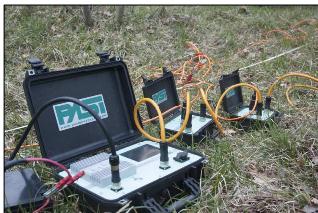
Foto 8 - Sistema di acquisitore per tomografia elettrica a corrente alternata POLARES 2.0 - PASI
