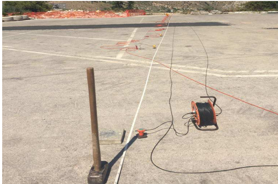
Foto 16: Stendimento sismico M5
