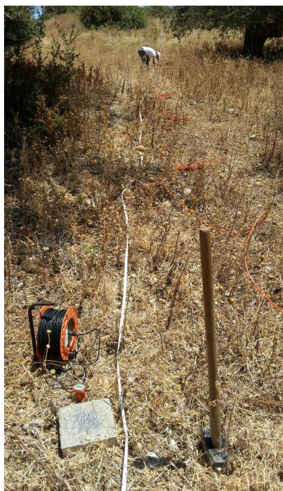
Foto 15: Stendimento sismico M4
