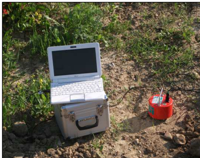
Foto 7 - Sismometro tricomponente Gemini 2 (PASI srl) utilizzato per l'acquisizione delle vibrazioni ambientali.
